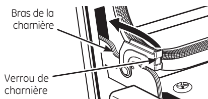
Pousser les verrous de charnière vers le haut pour verrouiller
