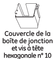
Vis à tête hexagonale n° 10 de 12,7 mm (1/2 po) de long pour boîte de jonction
