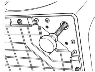
**REMARQUE :** Gardez l'extension des pattes à un minimum pour éviter une vibration excessive. Plus les pattes sont sorties, plus la laveuse vibre.
