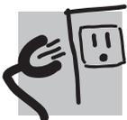
**Ne coupez pas ou n'enlevez pas, sous aucun prétexte, la troisième broche de mise à la terre du cordon d'alimentation. Pour des raisons de sécurité, cet appareil doit être correctement mis à la terre.**
