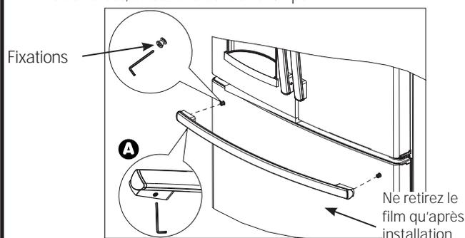
Réinstallez les poignées en utilisant la même procédure que pour les retirer.
