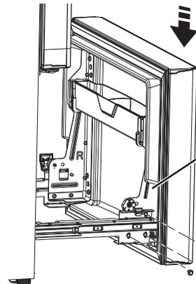
Alignez et insérez la languette du support de porte du congélateur dans la fente du support des glissières.
