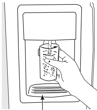
Bac de trop-plein
