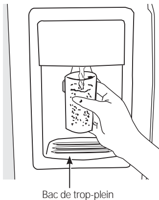
Bac de trop-plein
