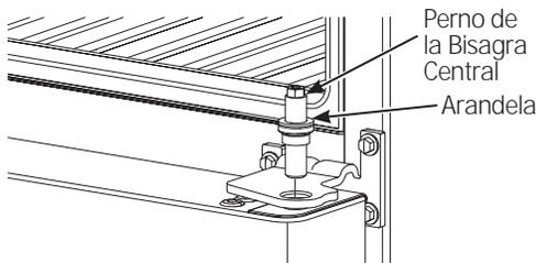
3.3 Retire la cinta e incline la puerta hacia fuera del gabinete. Levante la puerta del pasador en el soporte de la bisagra inferior. (Si la arandela plástica se pega al fondo de la puerta, colóquela de nuevo en la bisagra.)
