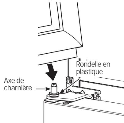
6.2.2 Inclinez la porte vers la carrosserie, en soulevant la charnière supérieure de façon que l'axe s'insère dans le logement dans le haut de la porte.
