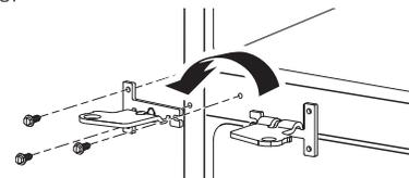
4.5 Retire los tornillos, sosteniendo la bisagra central al gabinete. Mueva la bisagra inferior de la derecha al lado izquierdo del gabinete. Cambie el perno de la bisagra al lado opuesto de la bisagra y reinserte los tornillos.
