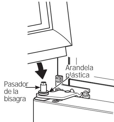
6.2.2 Incline la puerta hacia el gabinete, levantando la bisagra superior de modo que el perno calce en la ficha sobre la parte superior de la puerta.
