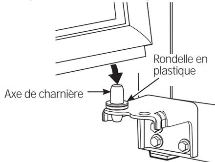
6.1.2 Inclinez la porte vers la carrosserie. Lorsque la porte arrive en position, alignez le logement dans la porte sur le trou dans la charnière centrale. Placez l'axe de charnière central dans le trou de la charnière centrale, puis serrez. Assurez-vous que la rondelle se trouve sur le dessus de l'axe.
