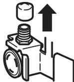
Inserte el extremo de la tubería en la conexión de la válvula del agua lo más que se pueda. Mientras sostiene la tubería, apriete el accesorio.
