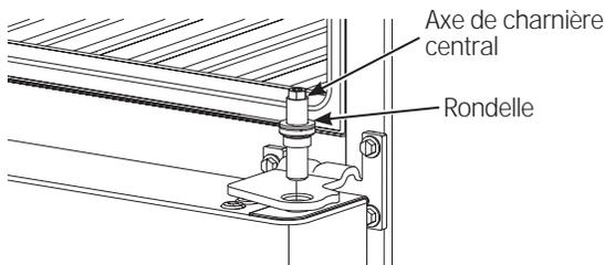
3.3 Enlevez le ruban et inclinez la porte en l'éloignant de la caisse. Relevez la porte de l'axe dans le support de charnière inférieure (si la rondelle en plastique colle au bas de la porte, replacez-la sur la charnière).
