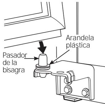
6.1.2 Incline la puerta hacia el gabinete. A medida que la puerta se coloca en su posición, Alinee la ficha en la puerta con el agujero en la bisagra central. Coloque el perno de la bisagra central en el agujero de la bisagra central y ajuste la misma con una llave de boca de 3/8". Asegúrese de que la arandela esté en la parte superior del perno de la bisagra.
