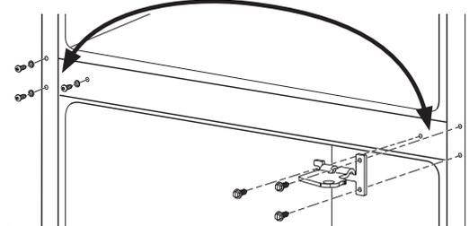
4.4 Vuelva a adherir la bisagra central con los tres tornillos del lado izquierdo del gabinete. NOTE: La bisagra central debe ser girada como se muestra, al ser montada del lado izquierdo.
