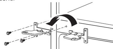
4.5 Enlevez les vis qui fixent la charnière inférieure à la carrosserie. Déplacez la charnière inférieure depuis la droite jusqu'au côté gauche de la carrosserie. Déplacez l'axe de charnière sur le côté opposé de la charnière et réinsérez les vis.
