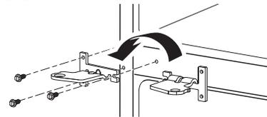
4.5 Enlevez les vis qui fixent la charnière inférieure à la carrosserie. Déplacez la charnière inférieure depuis la droite jusqu'au côté gauche de la carrosserie. Déplacez l'axe de charnière sur le côté opposé de la charnière et réinsérez les vis.
