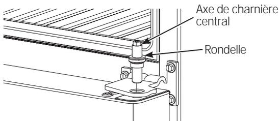
3.3 Enlevez le ruban et inclinez la porte en l'éloignant de la caisse. Relevez la porte de l'axe dans le support de charnière inférieure (si la rondelle en plastique colle au bas de la porte, replacez-la sur la charnière).
