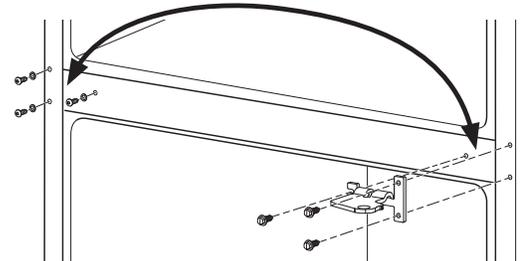
4.4 Reposez la charnière centrale avec les trois vis du côté gauche de la carrosserie. **NOTA :** La charnière centrale doit être retournée comme illustrée lorsqu'elle est montée du côté gauche.
