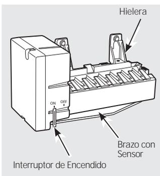
**PRECAUCIÓN** Evite el contacto con las partes en movimiento del mecanismo expulsor o con el elemento de calefacción (ubicado en la parte inferior de la máquina de hielo) que expulsa los cubos. No coloque los dedos ni las manos en el mecanismo de la máquina de hielo automática mientras el refrigerador esté enchufado.
