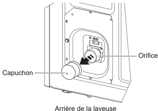
Raccordez le tuyau d'évacuation à l'orifice d'évacuation à l'arrière de la laveuse. Ouvrez le collier de serrage avec une pince et glissez-le sur le bout du tuyau. En maintenant le collier ouvert, poussez le bout du tuyau dans l'orifice d'évacuation jusqu'à ce qu'il repose au fond. Relâchez le collier entre les nervures de localisation sur le bout du tuyau
