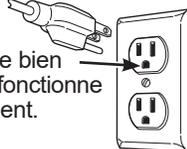
La laveuse doit être correctement mise à la terre conformément aux codes locaux de l'électricité, ou dans l'absence de codes locaux, à la dernière édition du Code Électrique National, ANSI/NFPA NO. 70 ou au Code Électrique Canadien CSA C22.1. Demandez à un électricien agréé de vérifier la connexion si vous n'êtes pas certain que la laveuse est correctement mise à la terre.
