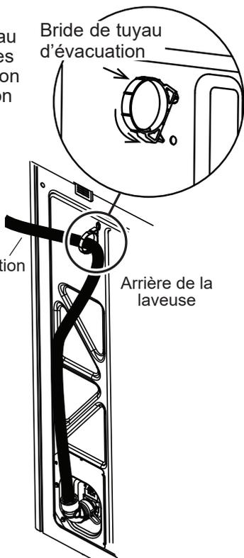
Si les robinets d'admission d'eau et le drain sont intégrés dans le mur, attachez le tuyau d'évacuation à l'un des flexibles d'alimentation en eau à l'aide de l'attache de câble fournie.
