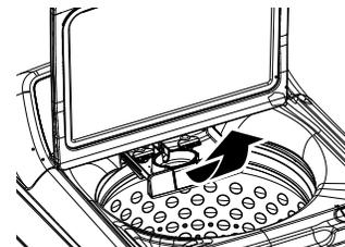
Les modèles GTW720 et GTW725 sont dotés d'un grand tiroir de distribution avec des compartiments pour le détergent et le produit assouplissant.
