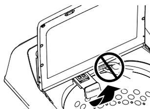
Les modèles GTW840 et GTW845 sont dotés d'un petit tiroir de distribution avec un seul compartiment pour produit assouplissant ou conditionnant.
