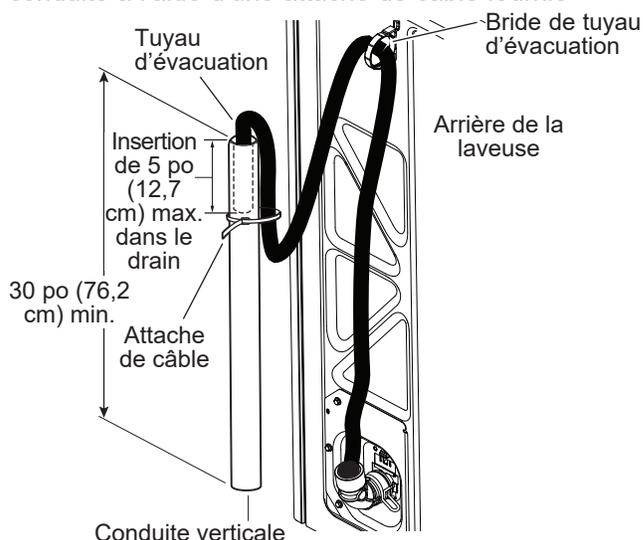
**REMARQUE :** Si vous mettez le tuyau de vidange trop bas, le tuyau d'égout peut causer un effet de siphon. On ne peut pas mettre plus que 12,7 cm (5 po) de tuyau dans le tuyau dégout. Il doit y avoir un espace d'air autour du tuyau de vidange. Un ajustement trop serré peut également produire un effet de siphon. Attache de câble Attache de câble.
