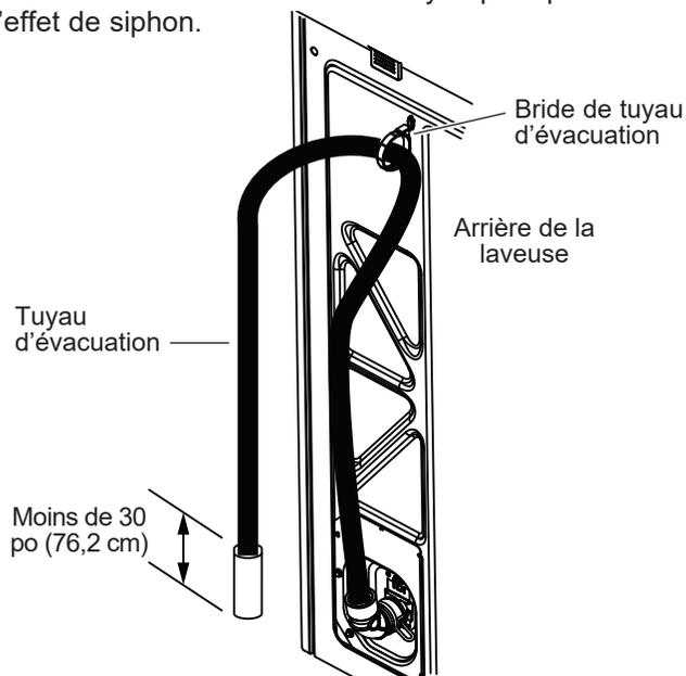
**REMARQUE :** Si vous mettez le tuyau de vidange trop bas, le tuyau d'égout peut causer un effet de siphon. On ne peut pas mettre plus que 12,7 cm (5 po) de tuyau dans le tuyau dégout. Il doit y avoir un espace d'air autour du tuyau de vidange. Un ajustement trop serré peut également produire un effet de siphon.
