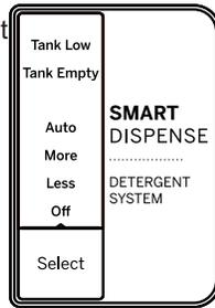
Si l'on souhaite sélectionner manuellement la quantité de détergent pour une brassée particulière, il s'agit de presser le bouton **Select** sur le panneau de commande **Smart Dispense** (distribution intelligente) pour choisir entre **Less** (moins) ou **More** (plus) de détergent. **Less** (moins) va fournir moins de détergent que **Auto** et **More** (plus) en fournira plus que **Auto**.
