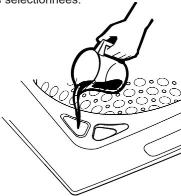
Lorsque le voyant **Tank Low** (réservoir bas) ou **Tank Empty** (réservoir vide) est allumé, plus de détergent doit être ajouté au réservoir pour assurer la disponibilité de détergent pour le prochain cycle.
