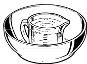
Configuration pour tester la réaction d'un ustensile au four à micro-ondes.
