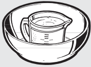
Configuration pour tester la réaction d'un ustensile aux micro-ondes.
