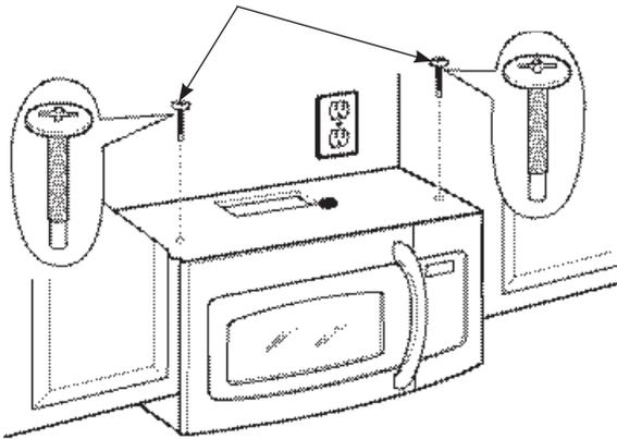
6 Serrez les deux vis de chaque côté dans le dessus du four à micro-ondes. (Tout en serrant les vis, soulevez l'avant du four à micro-ondes et poussez-le contre le mur et l'armoire supérieure.)
