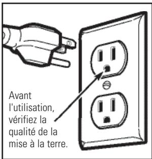
Pour diminuer les risques de chocs électriques, le cordon d'alimentation de cet appareil est muni d'une fiche à trois broches (mise à la terre) qui correspond à une prise murale à trois alvéoles (prise mise à la terre).
