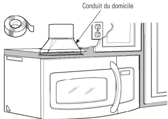
1 Tirez sur le conduit du domicile pour le raccorder à l'adaptateur d'évacuation.
