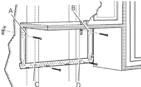
Fixez la plaque au mur à l'aide des boulons à ailettes. Vous devez utiliser au moins une vis à bois pour fixer la plaque à un montant. Les emplacements conseillés sur la plaque de montage sont indiqués par A, B, C et D.
