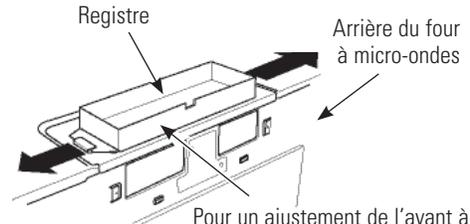
Pour un ajustement de l'avant à l'arrière ou de côté à côté, glissez l'adaptateur d'évacuation tel que requis
