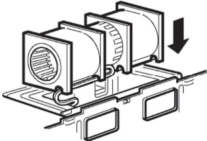
6 Fermez la porte du ventilateur. Fixez le ventilateur au four à micro-ondes en utilisant les vis de fixation des étapes 1 et 2.
