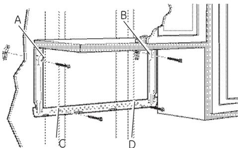
Fixez la plaque au mur à l'aide des boulons à ailettes. Vous devez utiliser au moins une vis à bois pour fixer la plaque à un montant. Les emplacements conseillés sur la plaque de montage sont indiqués par A, B, C et D.
