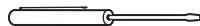
Petit Tournevis à Tête Plate (pointe de 2 à 2.4 mm ou 3/32", 60 mm de long)
