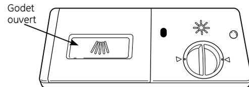
Pour ouvrir le couvercle du godet, appuyez sur le bouton. Le couvercle s'ouvrira en pivotant.
