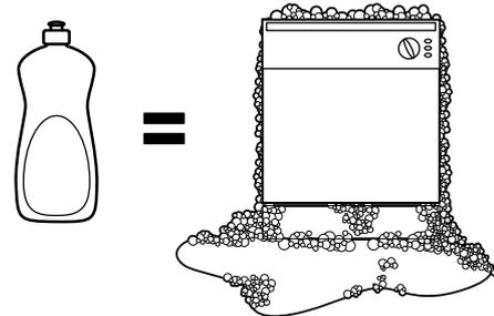
**REMARQUE :** Si vous utilisez un détergent qui n'est pas conçu pour les lave-vaisselle, il se formera de la mousse à l'intérieur de l'appareil. Pendant le fonctionnement, cette mousse sortira par les événements de l'appareil et s'écoulera sur le plancher de cuisine.
