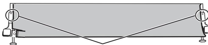
Pousser les côtés du matériau insonorisant derrière les trous de vis de fixation du coup-de-pied.
