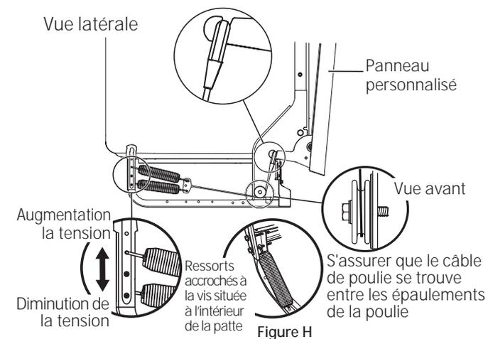
**Conseil:** Pour que la porte ouvre et se ferme facilement. Vérifiez la porte en l'ouvrant et en la fermant. Si elle n'ouvre pas facilement ou s'ouvre trop rapidement, vérifiez la disposition du câble du ressort. Le câble est retenu en place par des «épaulements» sur la poulie. Assurez-vous que le câble est bien installé sur les épaulements de la poulie comme indiqué.
