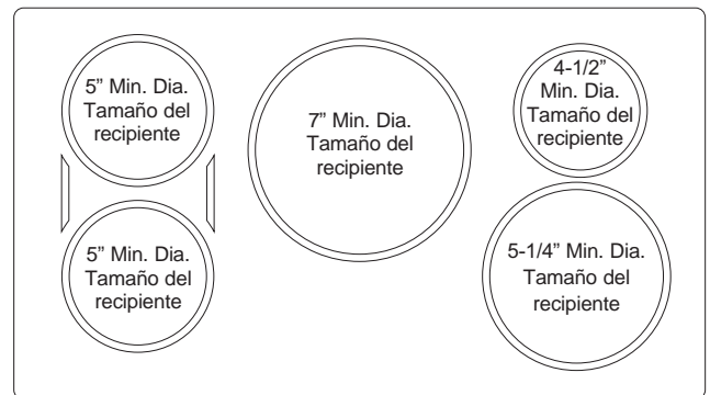
Estufa de 36" de ancho. Use el tamaño mínimo de cacerola recomendado, como se muestra para cada elemento de cocción.
