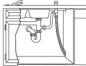
Installation avec un raccord en té d'égout
