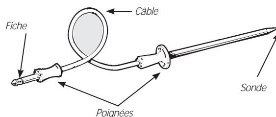
La sonde thermique ressemble à une broche pourvue à une extrémité d'une fiche que vous devez brancher dans la prise aménagée dans la voûte du four.
