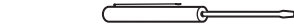
Destornillador plano pequeño (2 a 2.4 mm o 3/32" de tamaño de punta, 60 mm de largo)
