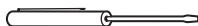
Petit tournevis à tête plate (de 2 à 2,4 mm ou 3/32 po dimension des pointes), 60 mm ou (2 3/8 po de long))
