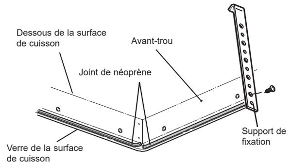
Vous pouvez commander auprès de votre détaillant une autre trousse d'installation (numéro WB01X24570) comprenant des écrous à oreilles et des supports. Consultez le schéma pour des instructions.
