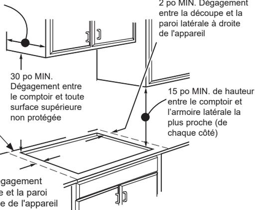
S'il ne vous est pas possible de laisser un dégagement de 30 po entre la surface de cuisson et les armoires en matériau combustible ou métal, vous devez laisser un dégagement minimum de 24 po et protéger le dessous des armoires au-dessus de la surface de cuisson avec du carton fort isolant d'au moins 1/4 po d'épaisseur recouvert d'une feuille de métal d'au moins 0,0122 po d'épaisseur.
