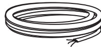
Circuit de dérivation à 2 fils et mise à la terre de 15 ou 20 A, 120 V/60 Hz, correctement mis à la terre
